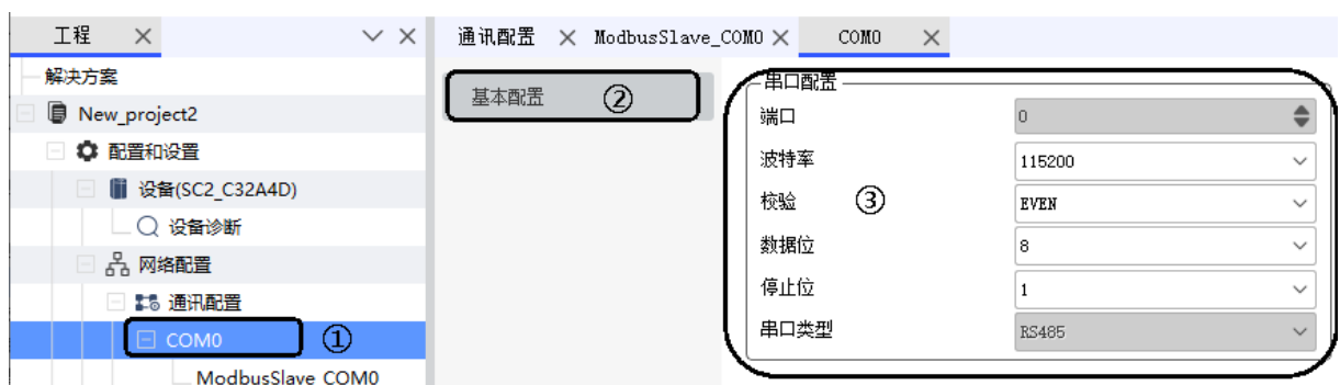
图：Modbus RTU 从站通讯参数设置
